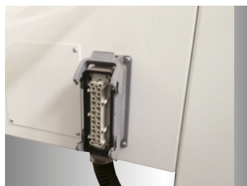
Attacco barre preparato · Attacco per caricatore barre Bar feeder connection · Bar feeder connection
