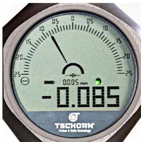
Nuovo 3D Tester con schermo digitale e scala numerica con risoluzione di mm.0,005, a mm.0,25 si accende la lancetta ed una luce verde per una lettura e visione migliore, se si supera lo zero la luce da verde diventa rossa (IP67)
