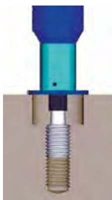
Diametro allargato per superfici di ampio appoggio.
